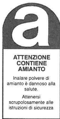
Etichetta di avviso di presenza di amianto
