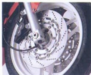
double disques flottants freinés par des étriers quatre pistons, double optique et échappement sport, et pour renforcer cette image sportive,
